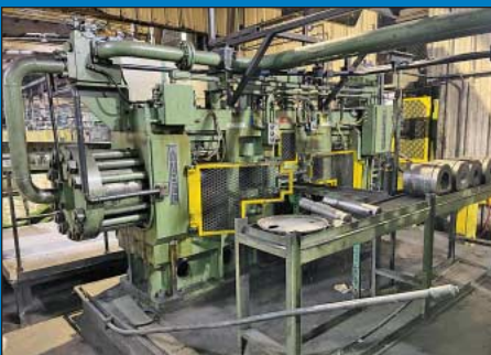
380 Ton Mitchell Double End Billet Piercing Press
