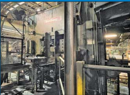
1,500 Ton Nordberg 3-Ram Billet Piercing Press
