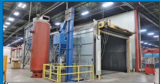
20' x 32' IST Blast Drive-Thru Blast Booth, Dust Collector and Reclaim
