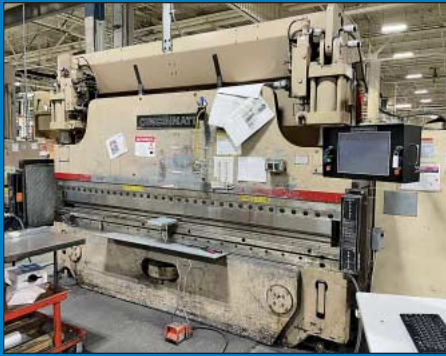
135 Ton x 12' Cincinnati Autoform CNC Press Brake
