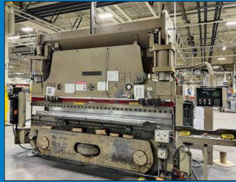
230 Ton x 12' Cincinnati Autoshape CNC Press Brake
